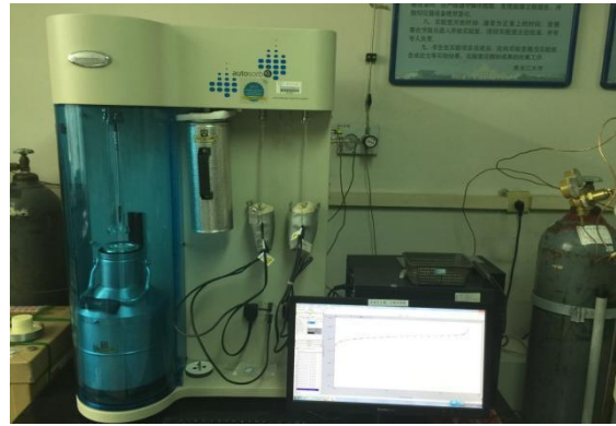
美国康塔公司的全自动比表面积与孔径分布测定仪
