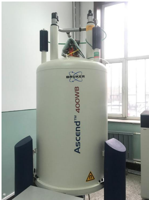
德国布鲁克公司 400 兆固体核磁共振波谱仪
